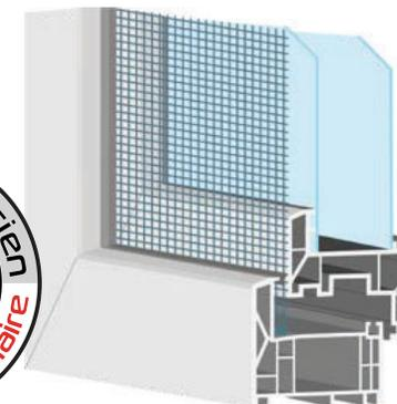
FlexScreen s'adapte sans profilé adaptateur aux fenêtres en PVC à surface décalée avec la spécification/géométrie représentée sur l'image. Espace requis dans le cadre de la fenêtre : 8mm
