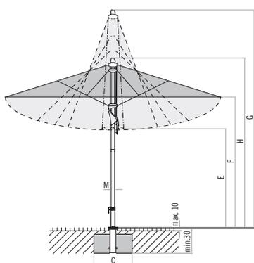
Revêtement de chaussée non fixé max. 10 cm, épaisseur du béton min. 30 cm (tenir compte de la profondeur hors gel), écoulement de l'eau
