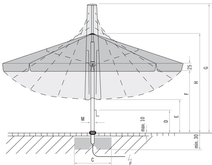
Revêtement de chaussée non fixé max. 10 cm, épaisseur du béton min. 30 cm (tenir compte de la profondeur hors gel), écoulement de l'eau, 1 câble d'alimentation électrique
